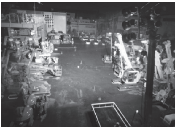
神奈川県川崎市での夜間デモ照明 30m奥の三角コーンやさらに奥の物まではっきりと視認できる
